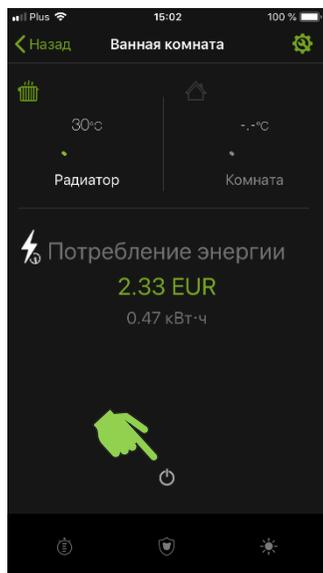
**Шаг 2. С помощью панели регулируется температура,** которую достигает и поддерживает ТЭН NEX APP.
