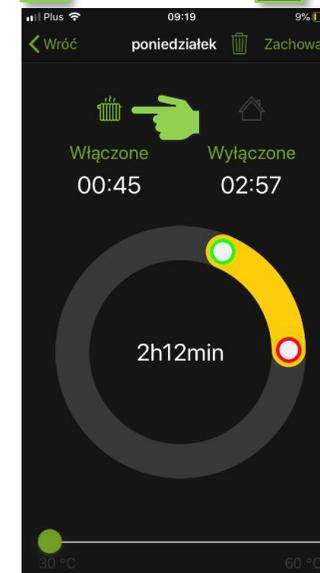
**Paso 4.** Especifique el **horario de funcionamiento** del calentador.
